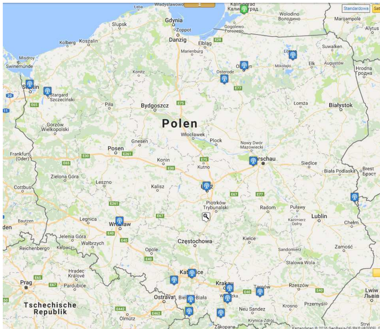
Rys. A.1. Mapa polskich przemienników DMR wg stanu z końca listopada 2016. Przemienniki zaznaczone na niebiesko pracują w paśmie 70 cm, a na zielono – w paśmie 2 m. Nie uwzględniono przemienników znajdujących się w fazie prób. Źródło: www.przemienniki.net
