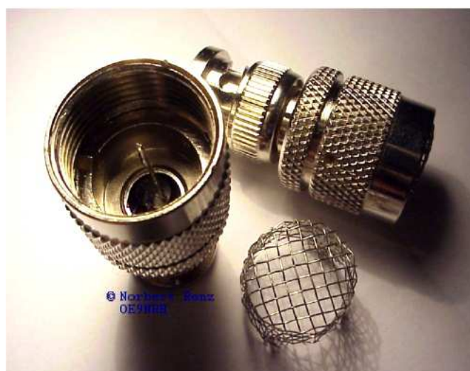
Fot. 4.10.1. Konstrukcja otwartej komory detektora ( www.elektronik-labor.de )
