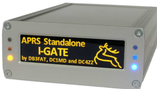
Fot. 4.1.2. Bramka internetowa APRS
