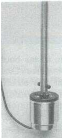
Rys. 4.1.7. Tachometryczny sposób pomiaru szybkości wiatru (źródło AATiS)
