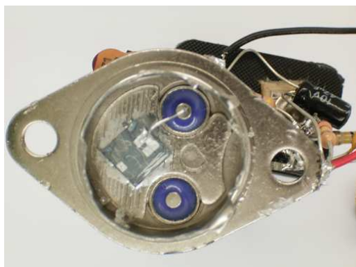
Fot. 4.9.1. Tranzystor BUZ45 z otwartą obudową. Struktura półprzewodnikowa pokryta warstwą ochronną
