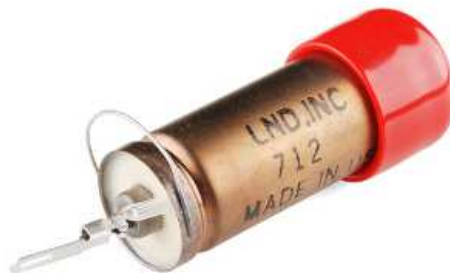
Fot. 4.11.3. Licznik Geigera-Müllera typu LND712 dla promieniowania alfa, beta i gamma jest wypełniony mieszaniną neonu i halogenu pod niskim ciśnieniem. Wysokie napięcie leży w zakresie 325 – 500 V
