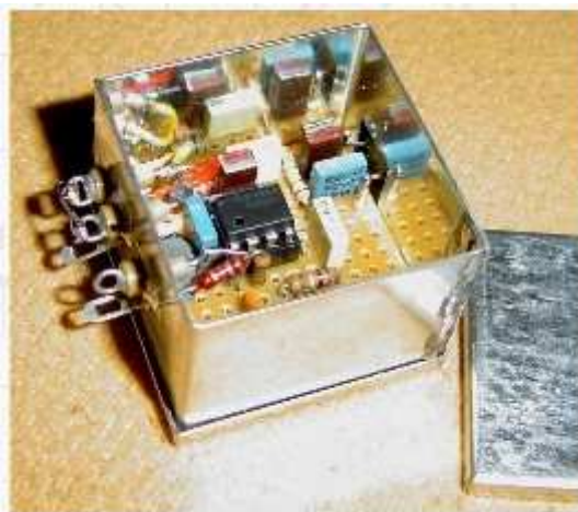
Rys. 4.8.2. Układ w obudowie ekranującej ( www.elektronik-labor.de )
