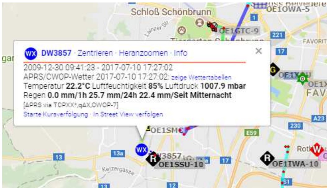
Rys. 4.1.6. Komunikat meteorologiczny APRS na tle mapy z witryny aprs.fi
