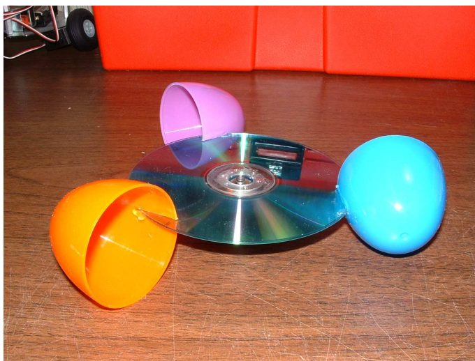
Rys. 4.1.1. Sposób wykonania wiatromierza (anemometru) z dysku CD i poówek plastikowych jajek. Dysk jest umieszczony na osi silniczka prądu stałego pracującego w tym przypadku jako generator
