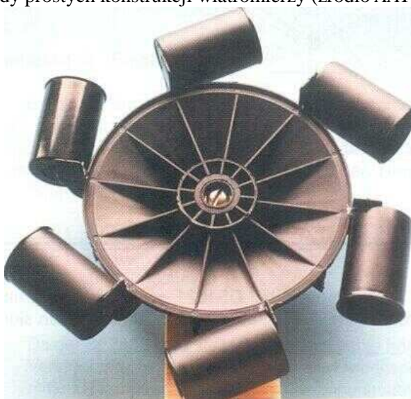
Rys. 4.1.4. Anemometr wykonany z opakowań od filmów (źródło AATiS)
