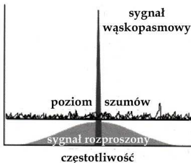
Rys. 4.2.1. Transmisja sygnału o rozproszonym widmie. Sygnał użytkowy jest po stronie nadawczej rozpraszany, a po stronie odbiorczej skupiany w identyczny sposób i przy użyciu identycznego kodu dla odzyskania danych w paśmie podstawowym. Ewentualnie odebrane sygnały wąskopasmowe znajdujące się w tym samym paśmie ulegają w odbiorniku rozproszeniu i nie powodują zakłóceń
