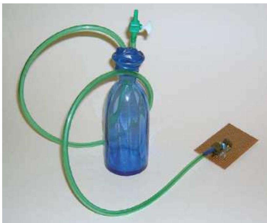
Fot. 4.3.2. Konstrukcja z wykorzystaniem butelki jako zbiornika odniesienia
